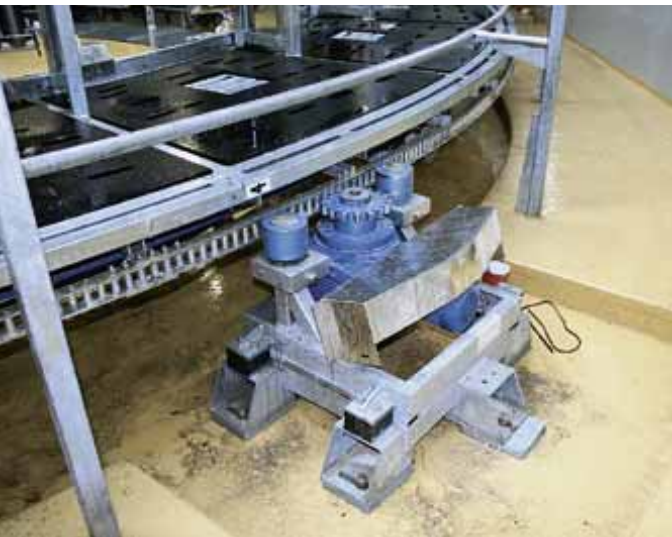
Die Plattform wird von einem Zahnstangenantrieb (ein Motor) angetrieben. Sie läuft auf fest stehenden Radsätzen. Fotos: Veauthier, Werkbild
