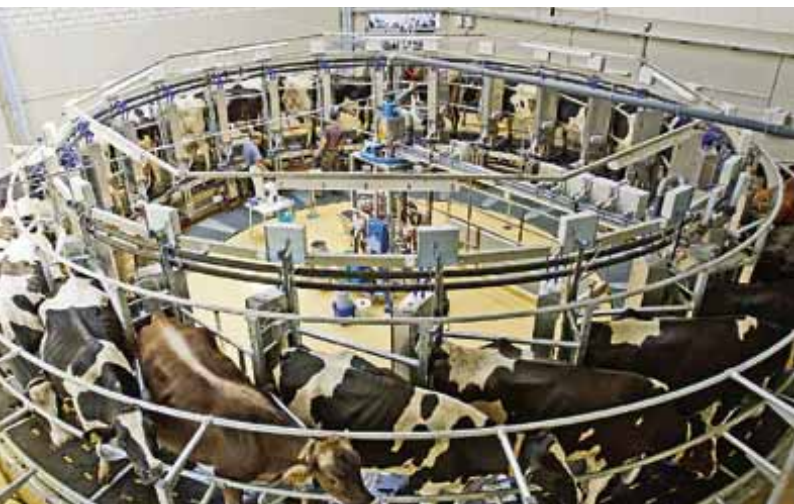
Das Melkkarussell verfügt über 24 Melkplätze. Der Zugang erfolgt über einen Tunnel.
