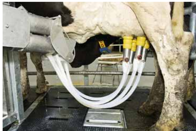
Viertelindividuelles Melken ohne Sammelstück: Die Melkbecher können sich frei unter dem Euter bewegen.
