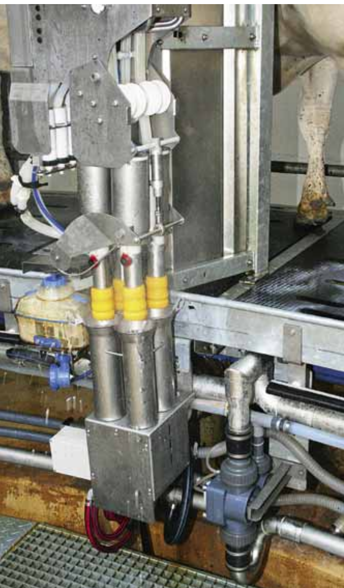
Nach jedem Melkvorgang werden die Melkbecher im Magazin desinfiziert, innen und außen gereinigt.
