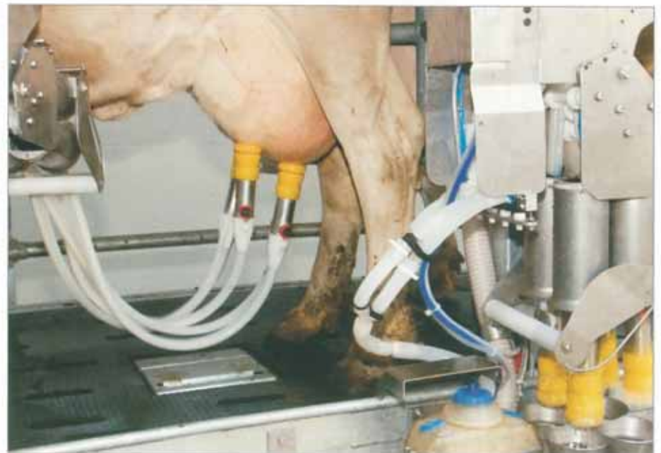
MultiLactor-Karussell MK 24 von Siliconform und Impulsa AG – hier wird im Melkstand viertelindividuell gemolken.
