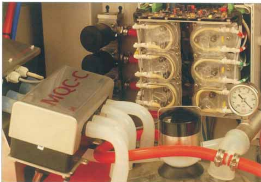
Das MQC-C-Milchqualitätskontrollsystem von Lely misst die somatische Zellzahl pro Viertel während der Melkung.
