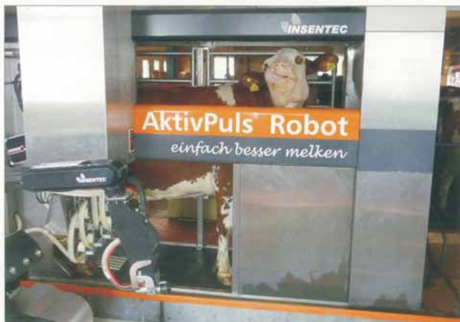
Der AktivPuls-Roboter von Happel ermöglicht niedriges Vakuum in der Entlastungsphase des Pulszyklus.
