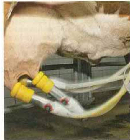
Abnahme: Alle Melkbecher werden nach dem Melken automatisch abgezogen und wieder ins Magazin eingezogen.
