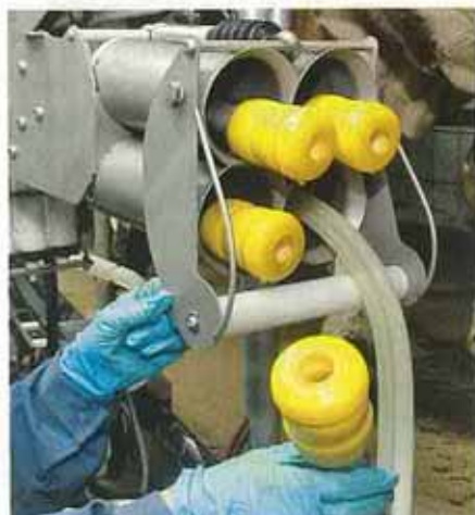
Ansetzen: Die Melkbecher werden einzeln aus dem Magazin gezogen. Es gibt kein Sammelstück mehr.
