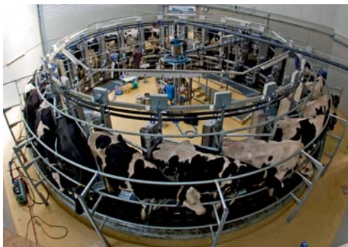
МультиЛактор в зале доения «Карусель» с 24 местами доения
